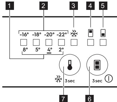
1. LED-indikator för invändig kyltemperatur
