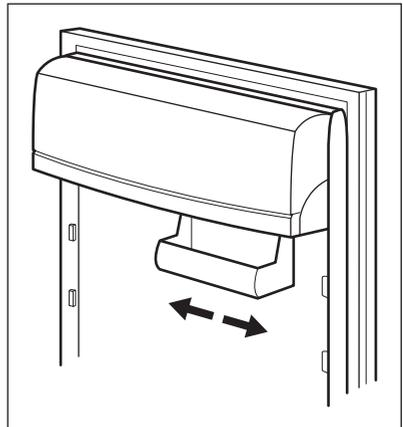
Ce modèle est équipé d'un compartiment de rangement variable qui peut être déplacé latéralement.
