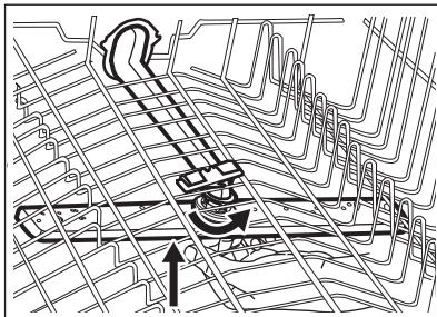
Takspolarmen är placerad i maskinens tak. Spolarmen (**C**) är installerad i tilloppsrören (**A**) med monteringselementet (**B**).
