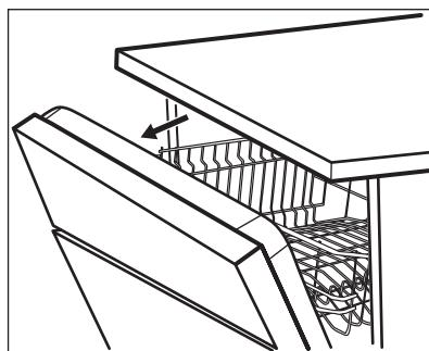
AirDry wird bei automatisch bei allen Programmen außer bei Vorspülen eingeschaltet.
