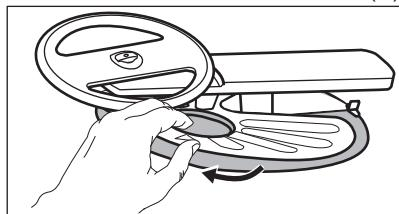
4. Reinigen Sie die Filter.
