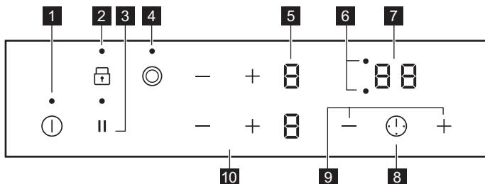
Laitetta käytetään kosketuspainikkeilla. Näytöt, merkkivalot ja äänimerkit ilmaisevat, mitkä toiminnot ovat käytössä.
