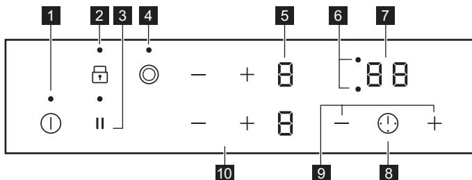
Brug sensorfelterne til at betjene apparatet. Display, kontrollamper og signaler viser de funktioner, der er i brug.
