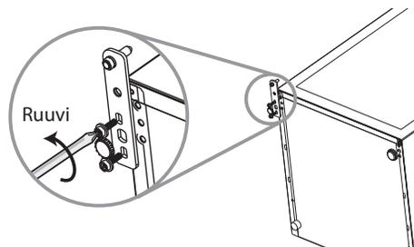
8. Aseta ovi takaisin paikalleen. Varmista, että ovi on kohdistettu vaaka- ja pystysuunnassa niin, että tiivisteet ovat tiiviit kaikilla puolilla ennen yläsaranan lopullista kiinnittämistä.
