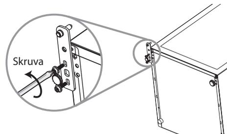
8. Sätt tillbaka dörren. Se till att dörren hänger rätt horisontellt och vertikalt och att tätningen är stängd på båda sidorna innan det övre gångjärnet slutligen dras fast.
