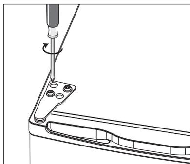
11. Aseta saranan suojus paikalleen ja ruuvaa suojus kiinni.
