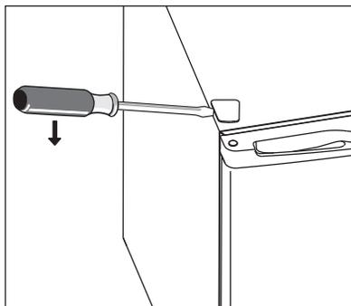
4. Flyt beslaget fra venstre side til højre side. Løft herefter lågen af, og læg den på en blød overflade så den ikke bliver ridset.
