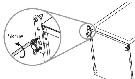
8. Sett døren på igjen. Kontroller at døren er riktig innrettet både horisontalt og vertikalt slik at pakningene er lukket på alle sidene før du til slutt strammer det øverste hengslet.
