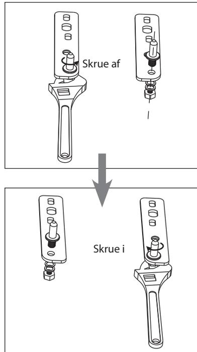
7. Sæt beslaget på den nederste hængespind igen. Sæt de justerbare fødder på igen.
