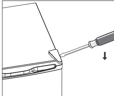
2. Løsne skruene. Fjern deretter hengselbraketten.
