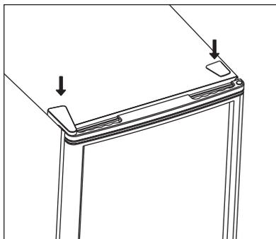
12. När dörren är stängd kontrollera att dörren hänger rätt horisontellt och vertikalt och att tätningen är stängd på båda sidorna innan det undre gångjärnet slutligen dras fast. Justera de höjbara fötterna om så behövs.
