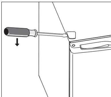
4. Flytt hulldekslet fra venstre til høyre side. Løft deretter døren av og sett den på en myk overflate så den ikke blir ripet.
