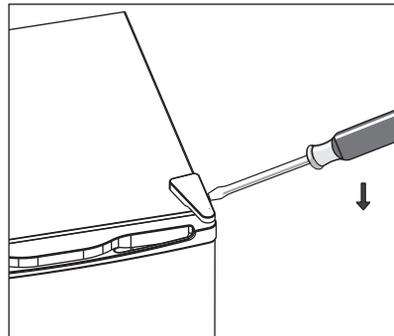
2. Lossa skruvarna. Ta bort gångjärnskonsolen.
